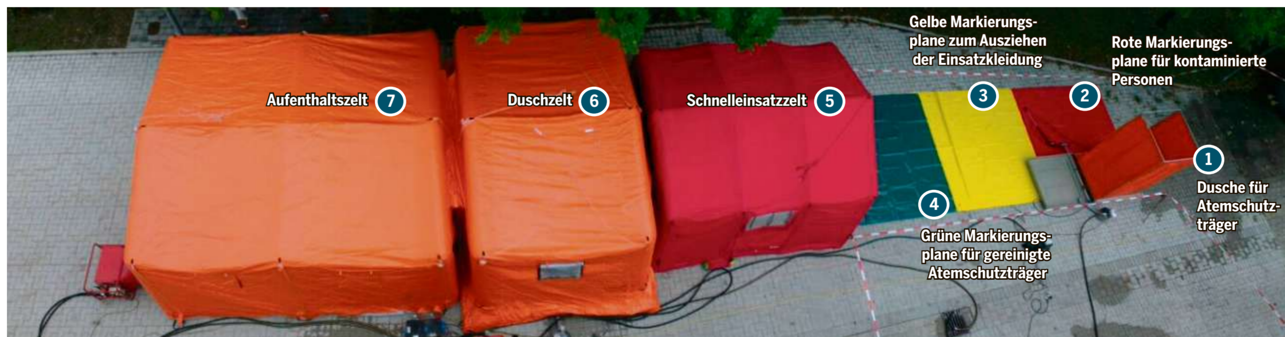
Rund eine halbe Stunde dauert es, die Dekon-P-Anlage aufzubauen. Dort werden die Atemschutzträger nach einem Gefahrguteinsatz in sieben Schritten gewaschen, entkleidet und dekontaminiert.
